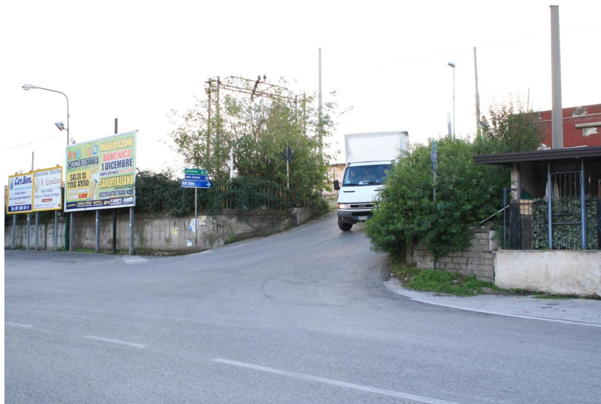
Intersezione con ridotta visibilità laterale per la presenza di vegetazione spontanea con crescita non controllata
