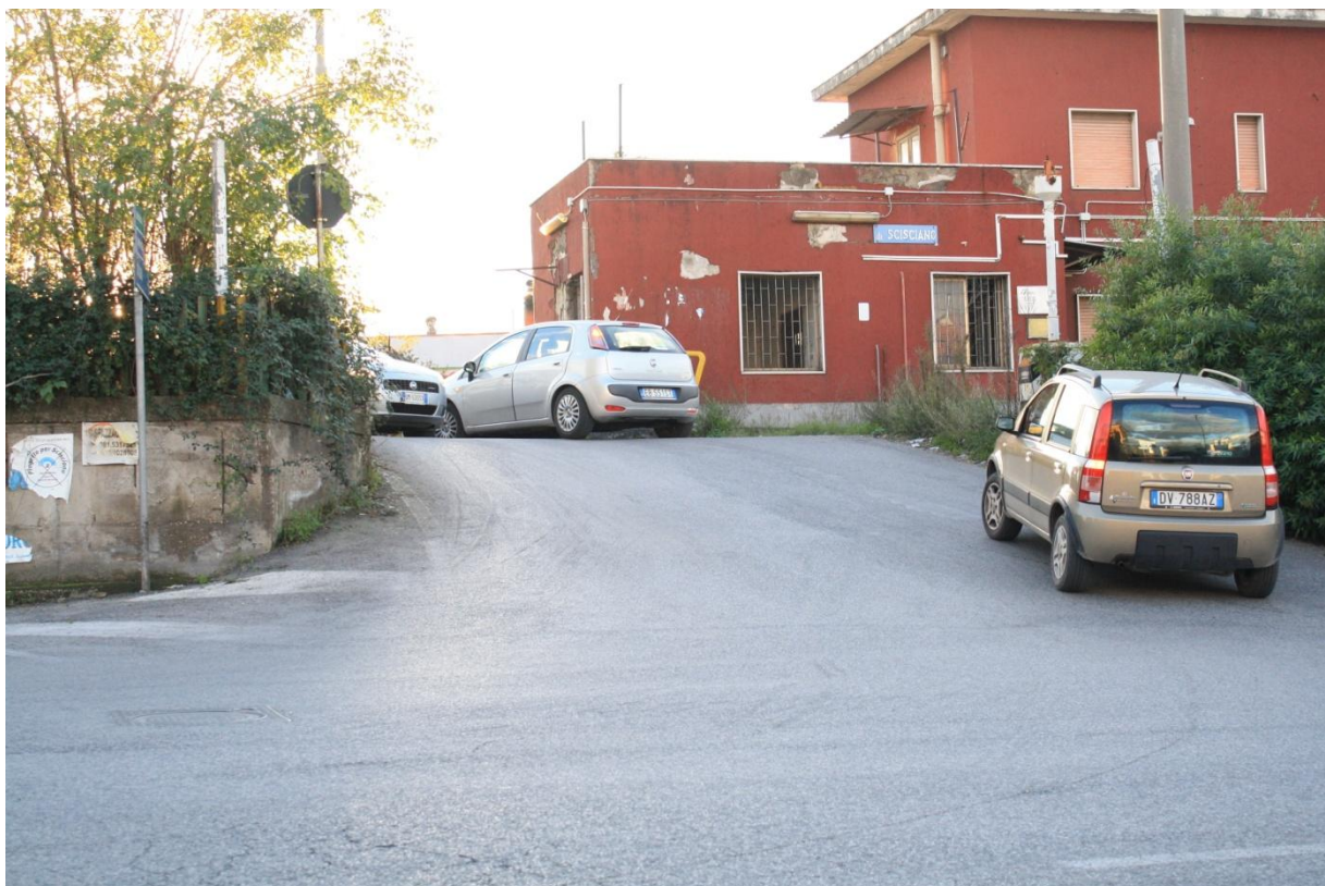
Restringimento della sezione in corrispondenza dell'intersezione con difficoltà di iscrizione in curva dei veicoli
